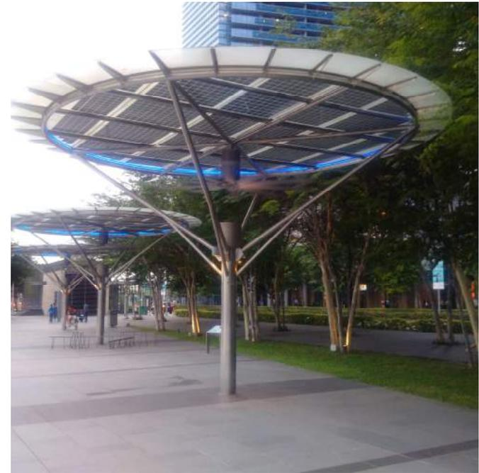
Environ 900 m<sup>2</sup> de surfaces de cellules photovoltaïques
